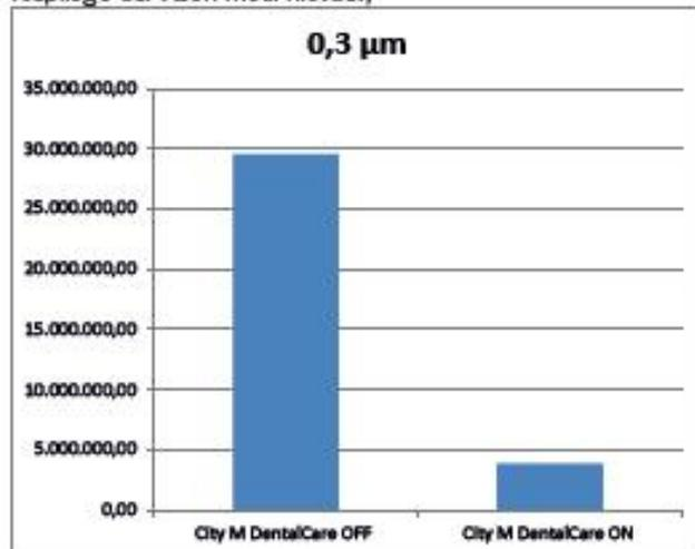
In questa pagina viene rappresentato graficamente l'abbattimento del particolato di dimensioni 0,3  $\mu\text{m}$ , 1,0  $\mu\text{m}$  e 5,0  $\mu\text{m}$  relativo al punto definito "riunito". Poiché le misurazioni effettuate senza purificatore d'aria fotografano una situazione omogenea in tutte le zone per tutte le dimensioni di particolato si è scelto di rappresentare il luogo più significativo, ossia quello posto al centro della sala chirurgica.
